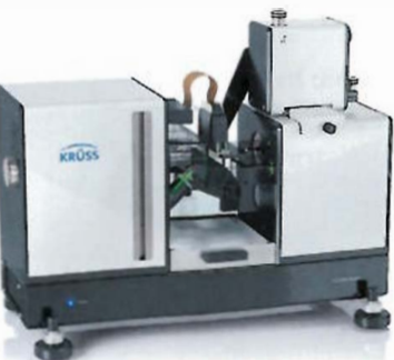
Der Drop Shape Analyzer DSA Inkjet von Krüss eignet sich zur Echtzeit-analyse von Tintentropfen.
